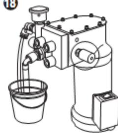
Поверните регулятор давления в положение LOW (до упора против часовой стрелки)
